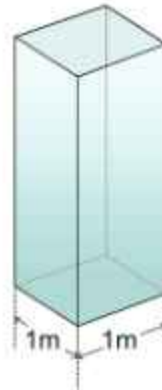
চিত্র 5.06: বাতাসের চাপটি আসে বাতাসের স্তম্ভের ওজন থেকে।
