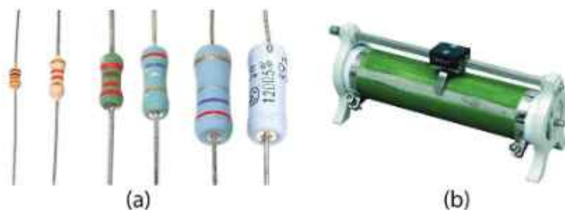
চিত্র 11.06: (a) স্থির এবং (b) পরিবর্তী রোধ
