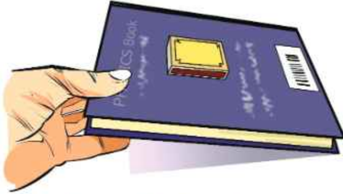
চিত্র 3.18: স্থিতি ঘর্ষণ সহগ পরিমাপ করা।
