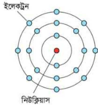
চিত্র 10.01: একটি আরপনের পরমাণুর মডেল। এক কক্ষপথ পূর্ণ করে ইলেকট্রন পরের কক্ষপথে যায়।
