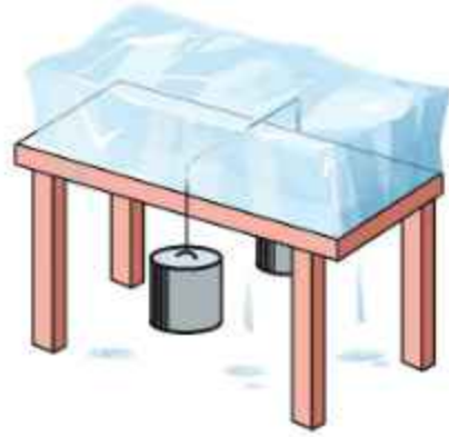
চিত্র 6.09: একটি বরফ খণ্ডকে সূক্ষ্ম তারের চাপ দিয়ে কাটা সম্ভব।
